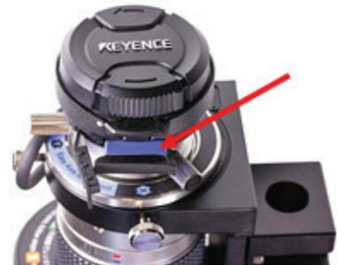
Die farbliche Markierung an der Basis des Barrierefilterhalters sollte dem Farbstreifen auf dem verwendeten Lichtkopf entsprechen.
