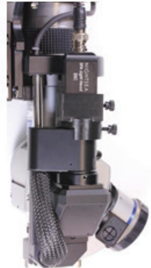
**Anmerkung 1** – Die Befestigung direkt am Objektiv bietet einen signifikanten Vorteil bei höheren Vergrößerungen. Im Bereich von etwa 200-300x lohnt es sich, die beiden Beleuchtungsmethoden zu vergleichen. Bei höheren Vergrößerungen wird immer die Montage direkt am Objektiv empfohlen. Wenn Ihre Probe eine starke Oberflächenstruktur hat und Schatten wirft, kann es auch nützlich sein, das Licht bei allen Vergrößerungen direkt am Objektiv einzukoppeln.
